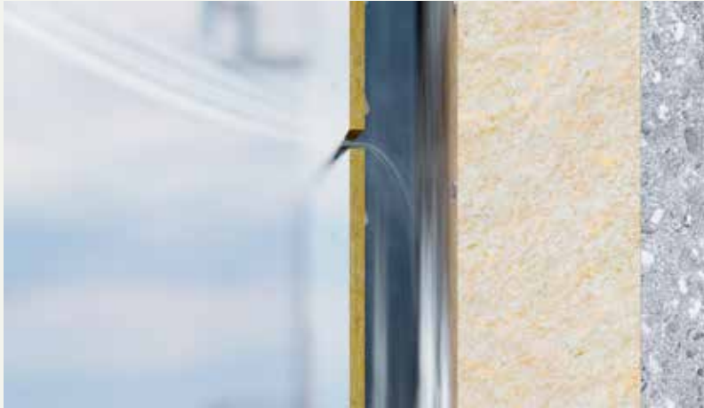
Ventilationseffekten bakom och genom fogen i fasadbeklädnaden
